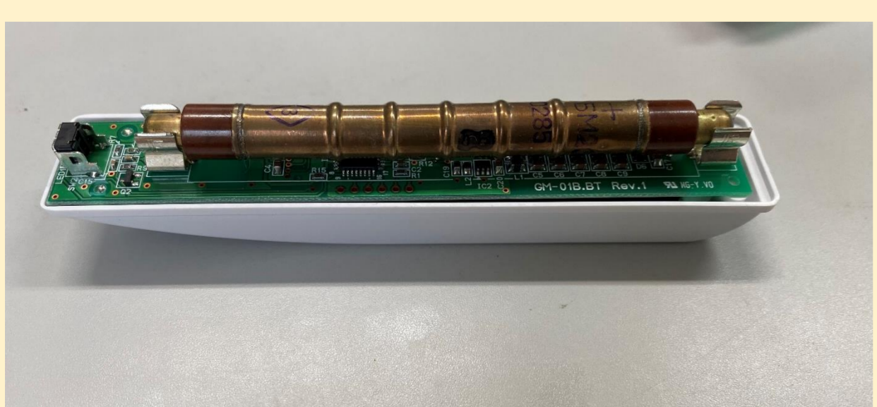
ギョロガイガー内部 茶色の筒がガイガー=ミュラー管である
