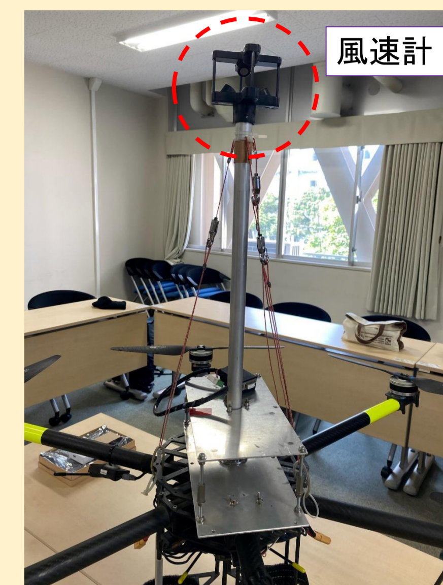
ドローン上部に設置されている風速計
